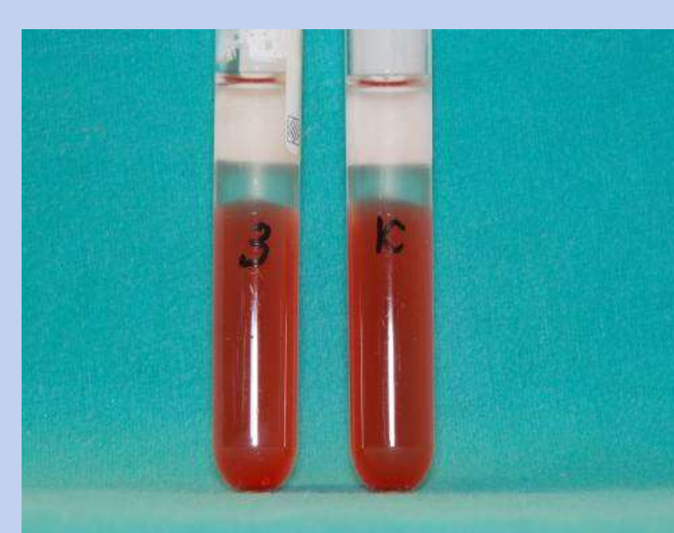
Wyciąg z opatrunku i kontrola (PBS) po inkubacji z krwią cytrynianową w temp. 37 C / 4 godz..
